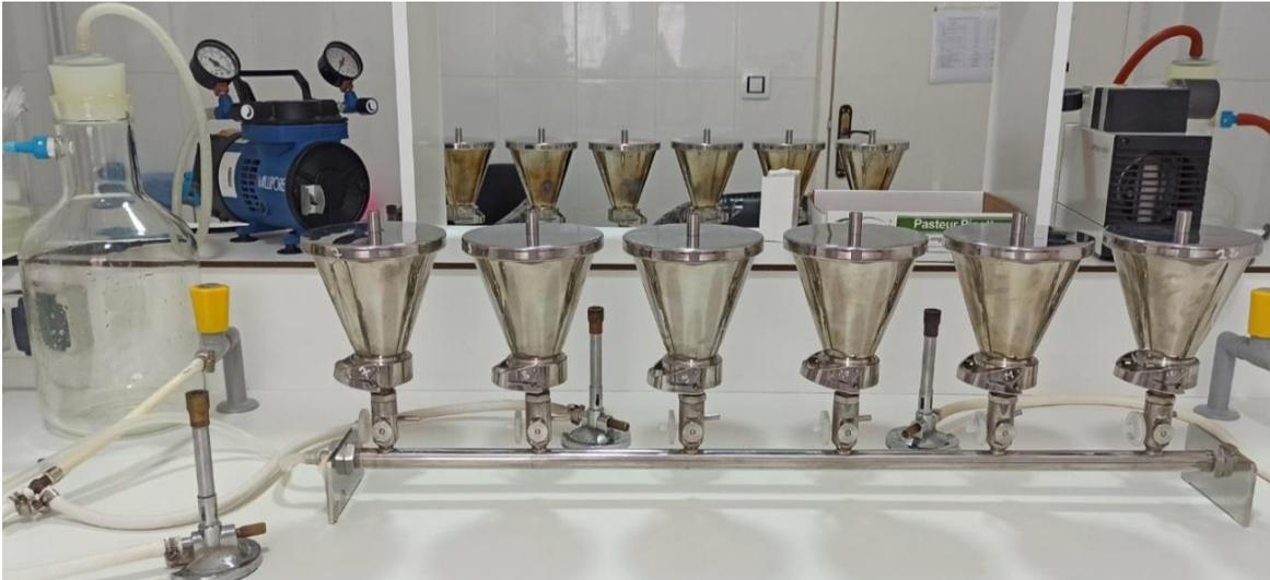
**Figure 5:** Rampe de filtration (Photographie originale, 2022).
