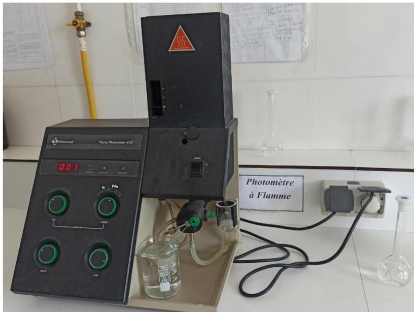
**Figure 10:** Spectrophotomètre à flamme (Photographie originelle, 2022).
