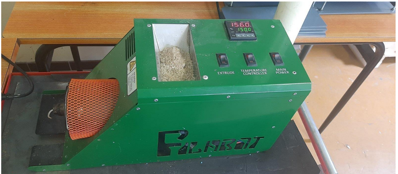
Figure. III.15. L'extrudeuse Fila-bot lors de l'extrusion
