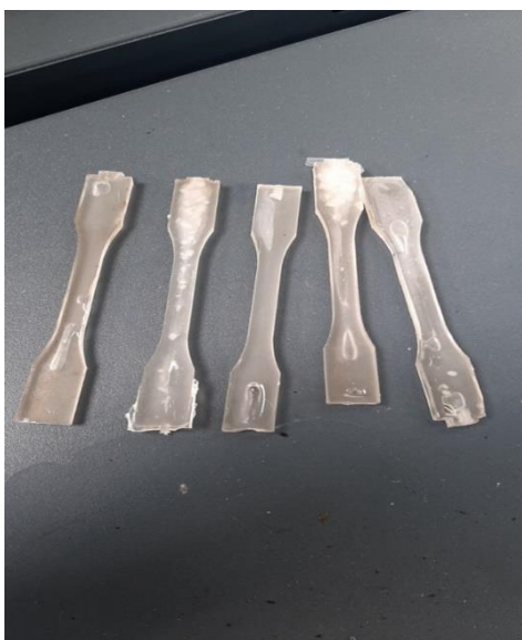
Figure. III.17. L'empreinte de l'éprouvette de traction
