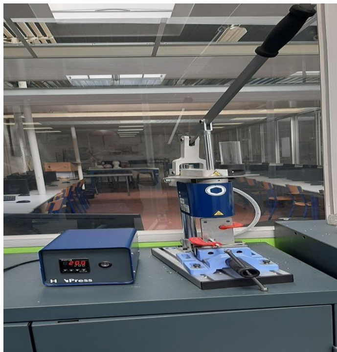
Figure. III.16. Presse à injection HoliPress V1.3
