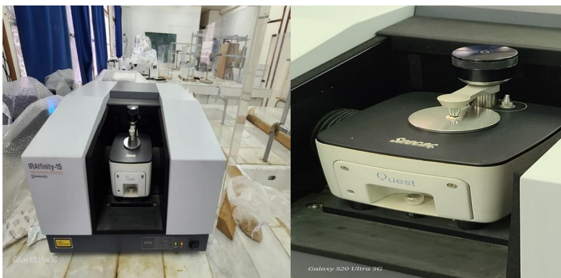
Figure. III.13. Photo représentative de l'appareil IRTF
