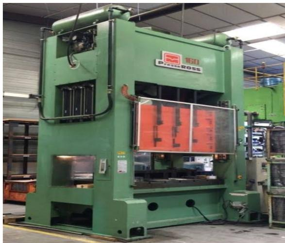
**Figure III.1: Presse Mécanique**
