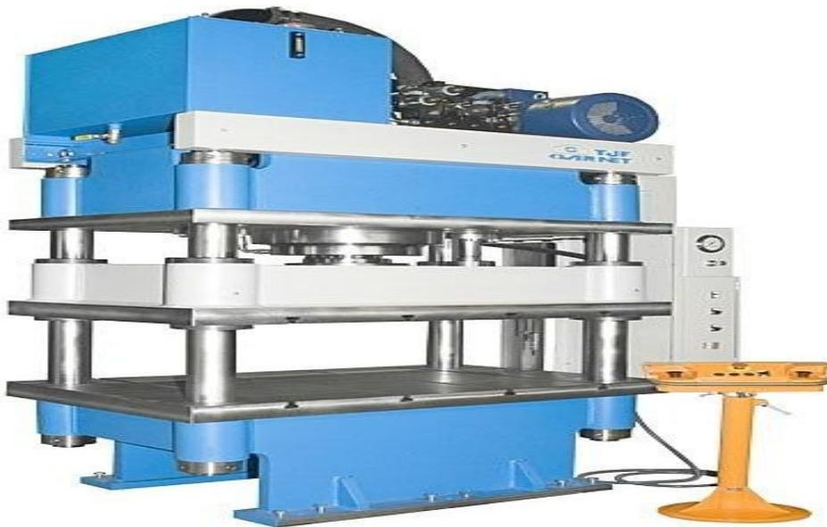
**Figure III.9: Presse à colonne.**
