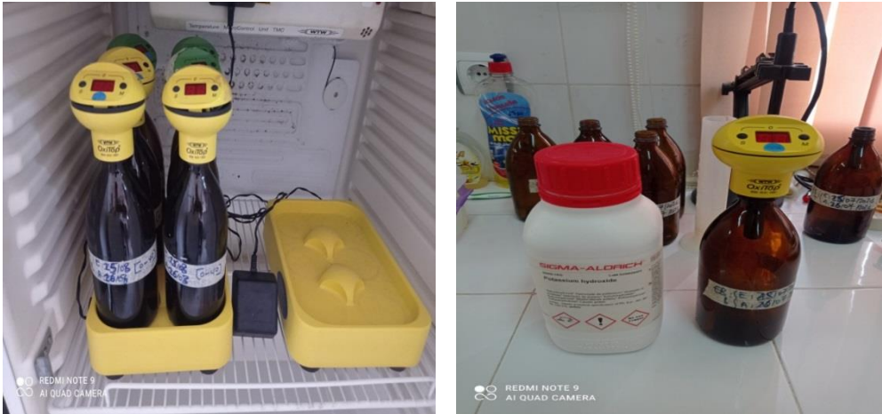
Figure 50 : Les outils utilisés pour l'analyse de la DBO5.
