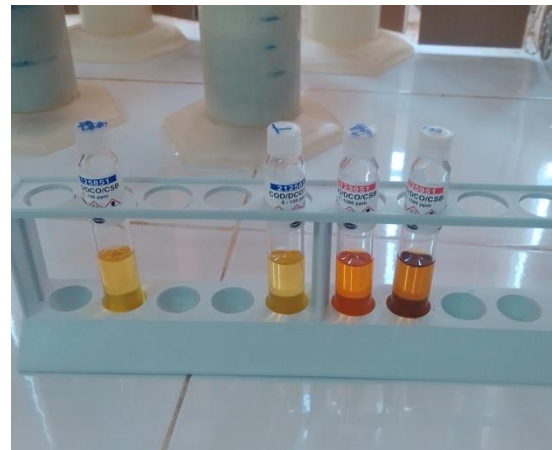
Figure 49 : Les outils utilisés pour la détermination du DCO avant et après l'analyse.
