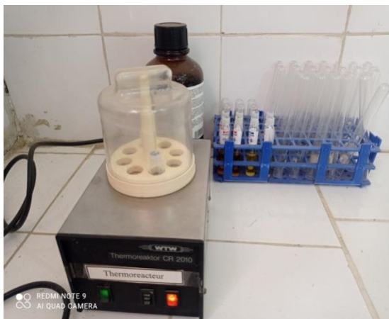
Figure 49 : Les outils utilisés pour la détermination du DCO avant et après l'analyse.
