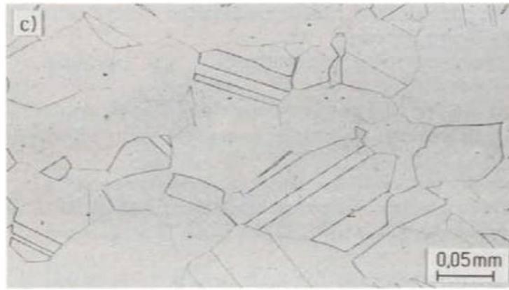
Figure I-2: Microstructures des aciers inoxydables austénitiques.
