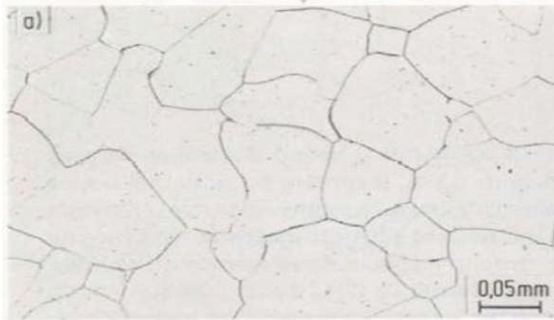
Figure I-1: Microstructures des aciers inoxydables ferritiques.
