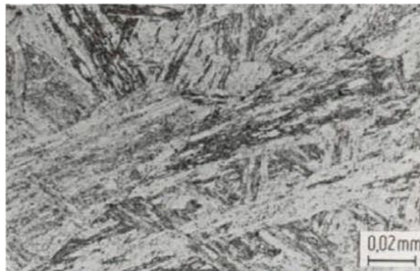
Figure I-4: Microstructure des aciers inoxydables martensitiques.
