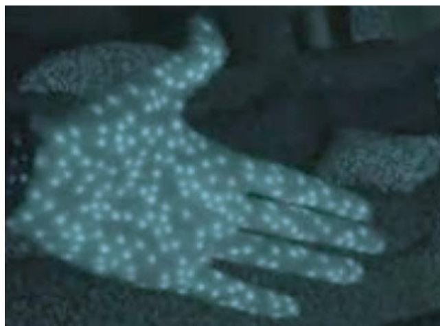
Figure 1.3 : Exemple de motif infrarouge projeté par la Kinect
