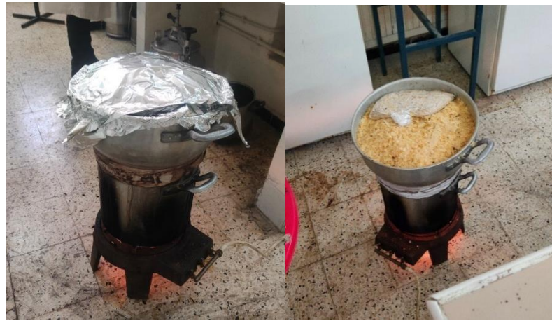
Figure 10 : Traitement thermique des substrats et du carbonate de calcium à l'aide d'un couscoussier (Photo originale, 2023).
