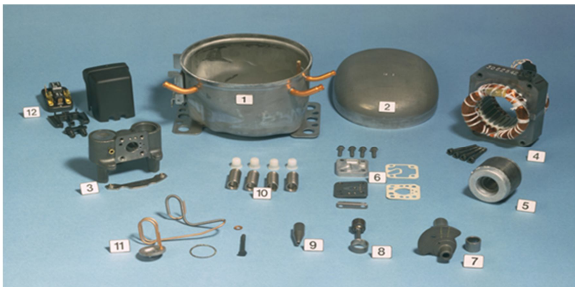
(Figure 3.12) vue éclatée d'un compresseur
