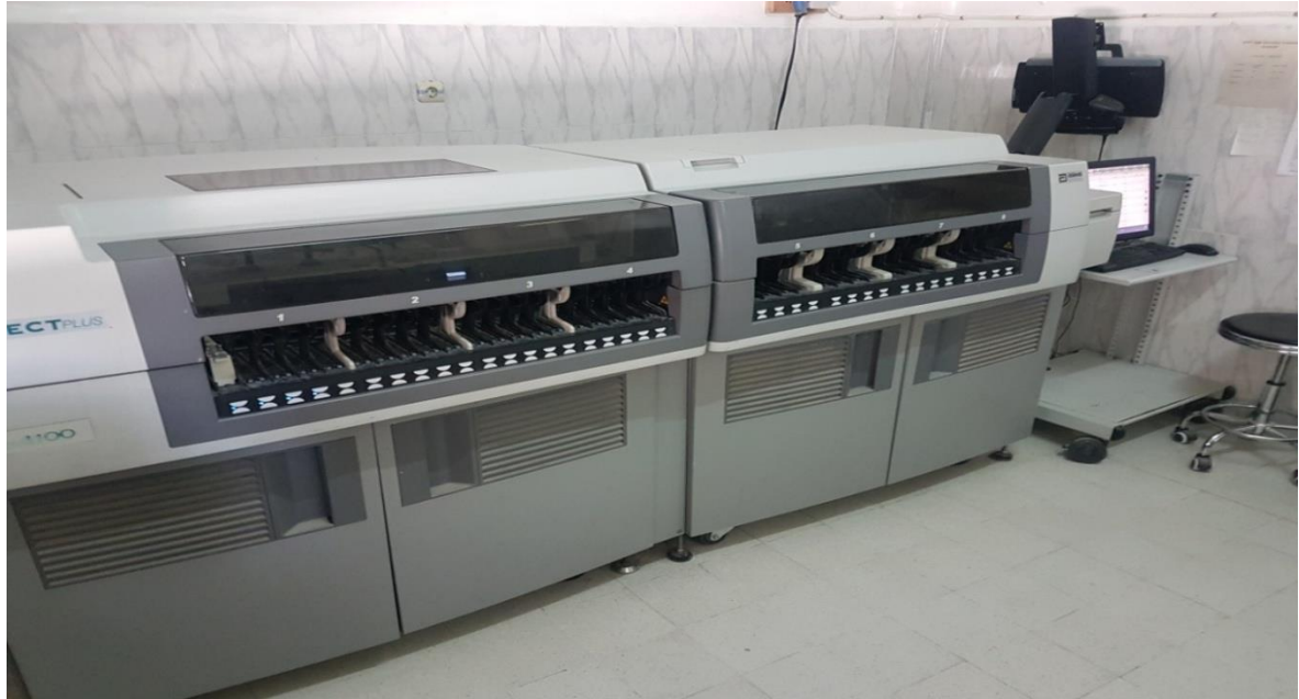
Figure 15. Automate Architect ci4100 utilisé dans le laboratoire de biochimie du CHU Tizi-Ouzou unité Nedir Mohammed [76].
