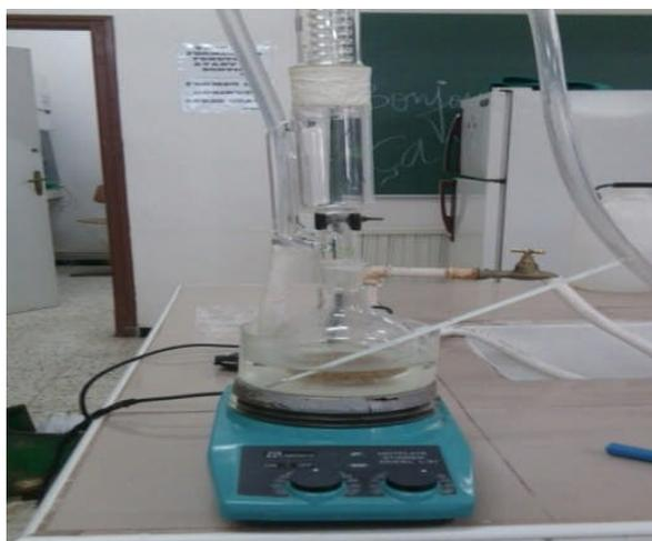
Figure 13: Montage de la réaction de solubilisation du chitosane dans l'acide acétique
