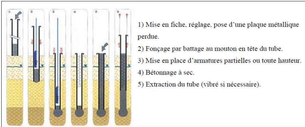
Figure I.12. Pieu battu moulé
