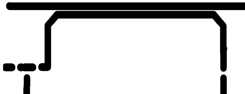
Figure III.9: typon du coupleur réalisé en échelle 1/1.
