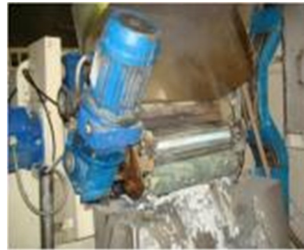
Figure I.6 : A gauche le vibrocrible et à droite le rouleau rotatif plus le tapis roulant
