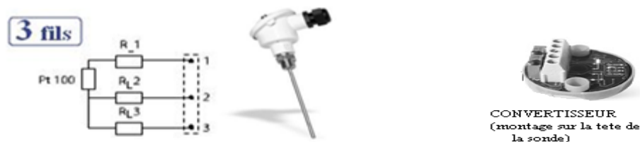
Figure-1.3- : Sonde de température PT100
