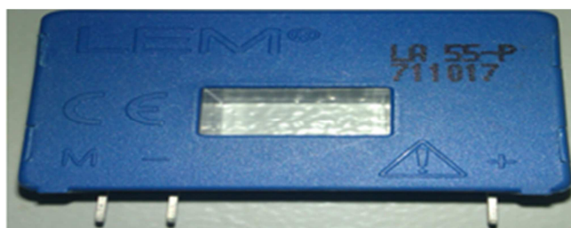
Figure IV.6 : Capteur de courant utilisé
