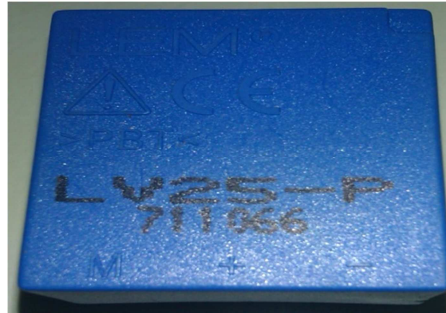
Figure IV.5 : Capteur de tension utilisé
