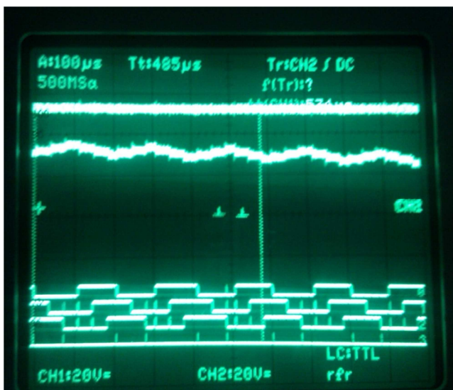
Figure IV.26 : formes d'ondes des tensions d'entrée/sortie du convertisseur
