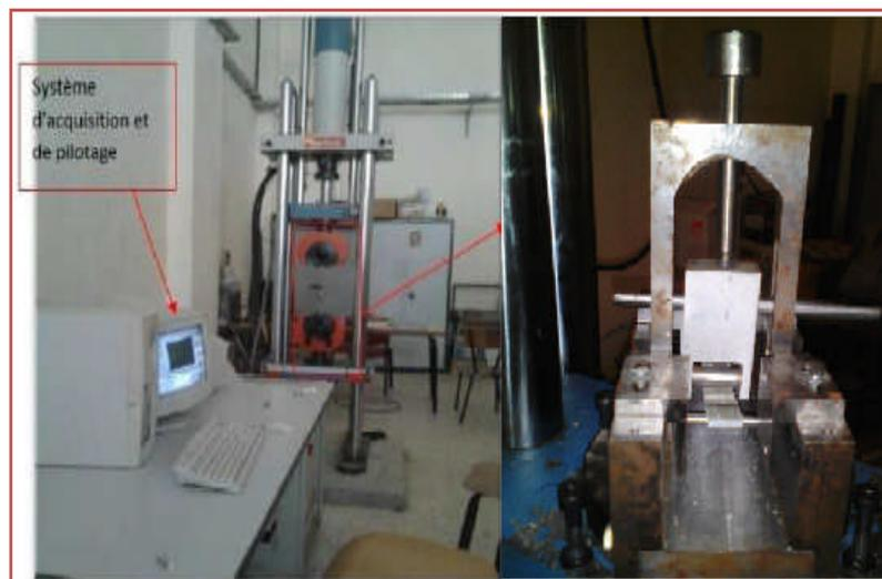
**Figure IV.8:** Machine de traction IBERTEST et le dispositif de flexion trois points
