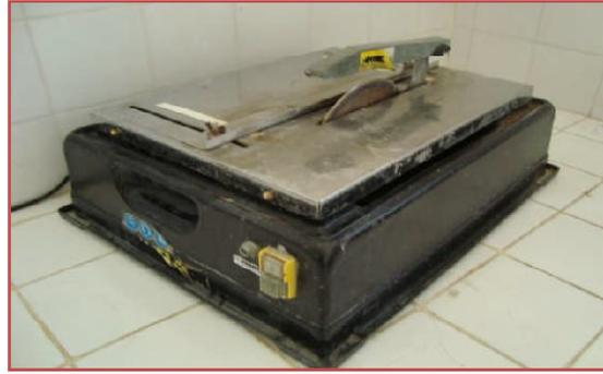
**Figure IV.4 :** Scie à disque diamanté
