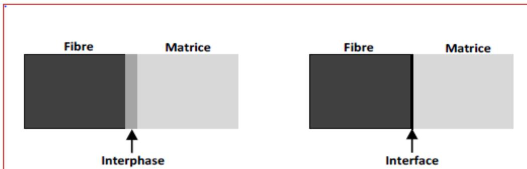
Figure 1.8 : concept d'interfaces et d'interphases
