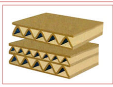
figure I.14: sandwich à âme creuse
