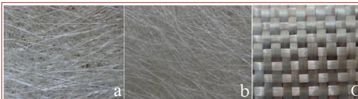
Figure IV.2 : Les différents renforts utilisés ; a) Mat 300g/m<sup>2</sup> ; b) Mat 450g/m<sup>2</sup>
