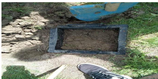
Figure 9: Quadra de 25*25cm de côté et de 10cm d'épaisseur enfoncé dans le sol (Originale, 2021).
