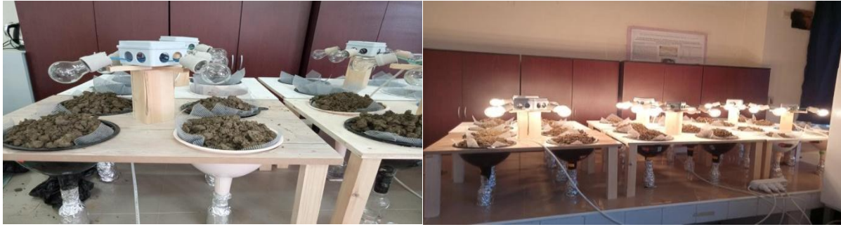
Figure 10 : Appareil de Berlèse Tullgren simplifié (Originale, 2021)
