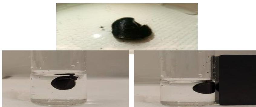
Figure III- 12 : Photographies de pastille de l'hydrogel magnétique - rGO.
