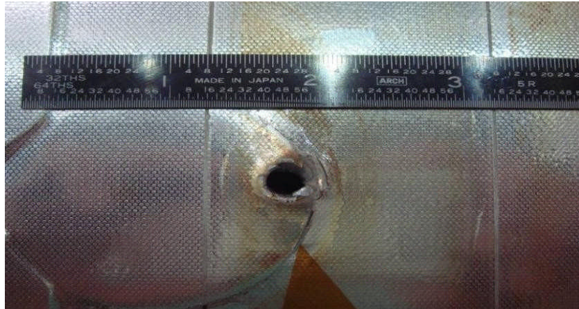
Figure 10 : Trou dans le radiateur de la navette spatiale américaine Endeavour provoqué par un débris. [2]
