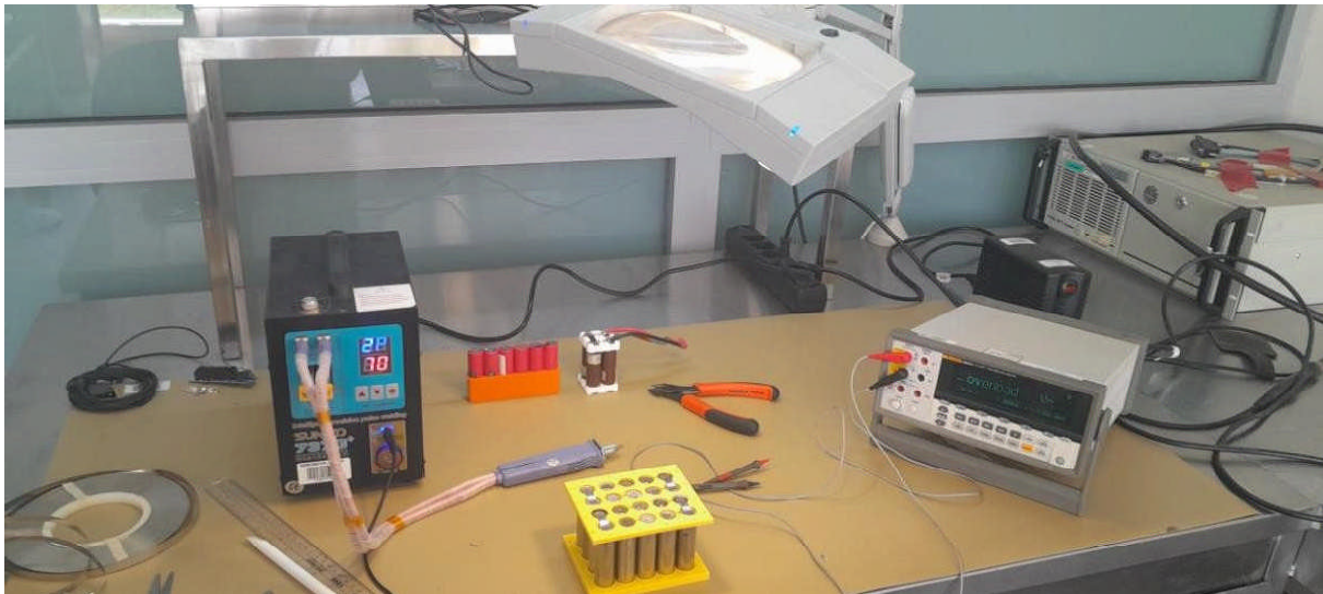
Figure 70 : processus de soudage par points par résistance
