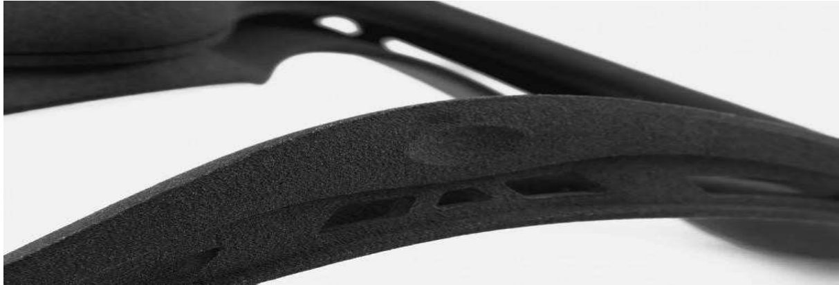
Figure 55 : Exemple d'une pièce imprimée avec impression 3D SLS [27]
