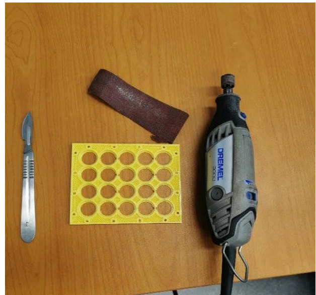
Figure 65 : Finition de la pièce
