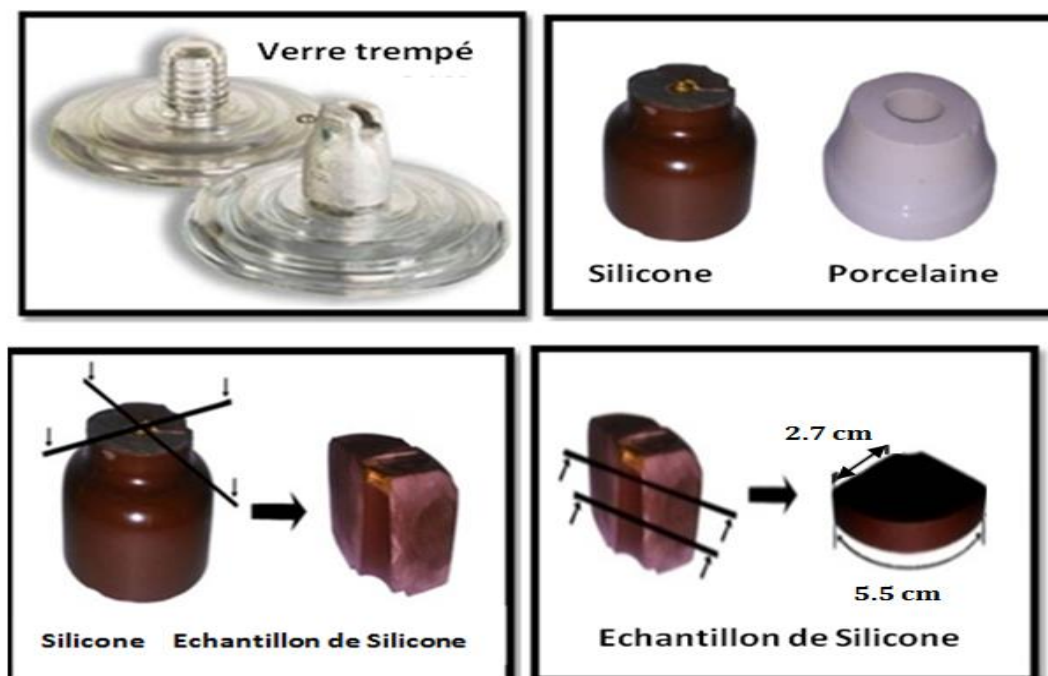
Figure II.4. Mode de découpage des échantillons en silicone et porcelaine.
