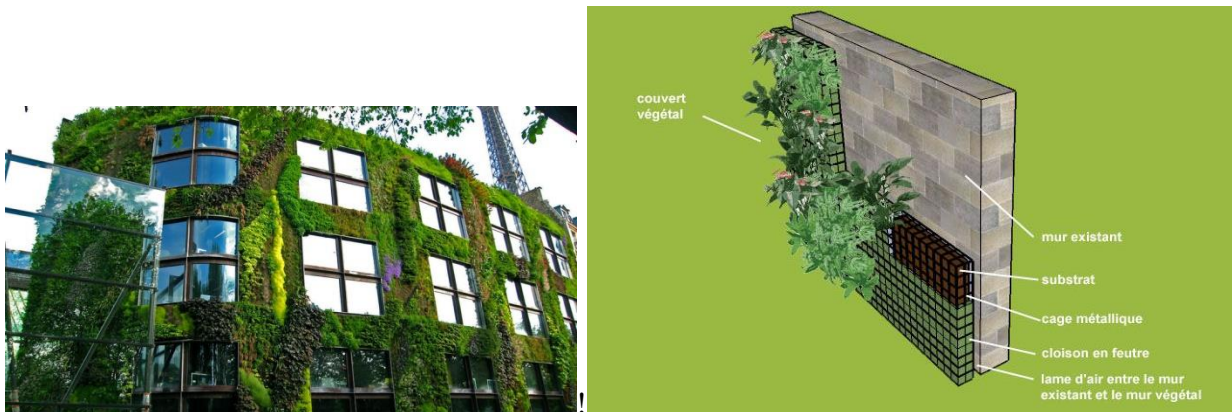
Figure 40: Exemple d'une façade végétalisée .
