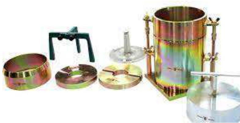
Figure 13 : Les appareils pour l'essai CBR
