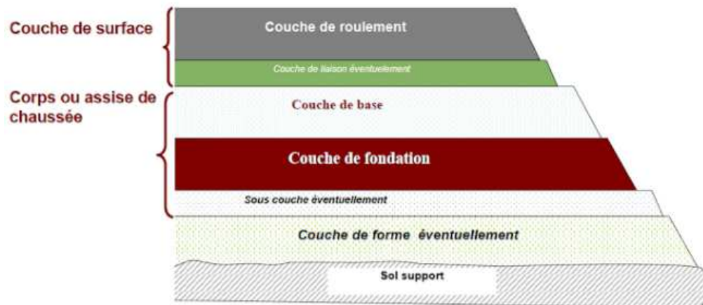
Figure 14: Coupe type d'une chaussée souple
