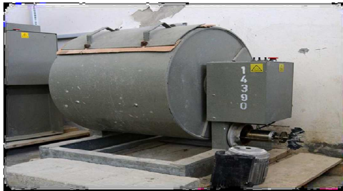
Figure 9 : La machine de Los Angeles
