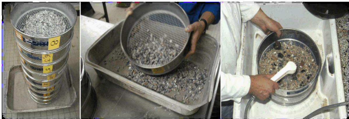
Figure 8 : Méthode d'exécution d'essai analyse granulométrie
