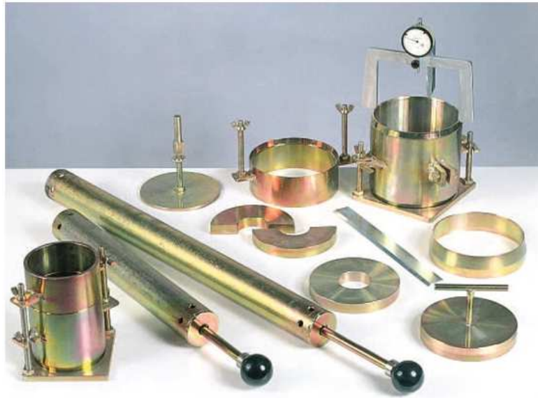
Figure 11 : Matériel pour l'essai Proctor
