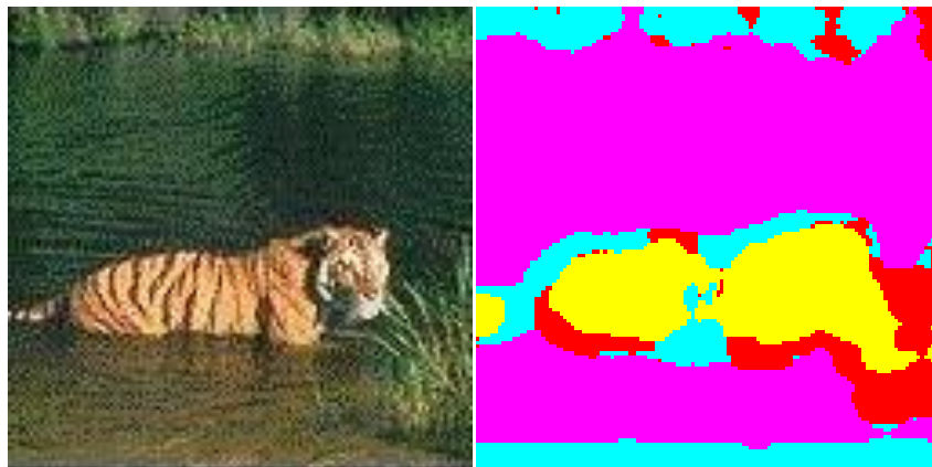
Figure 1.13 : Exemple de segmentation d'image, à droite image originale, à gauche image segmenté en 4 classes.
