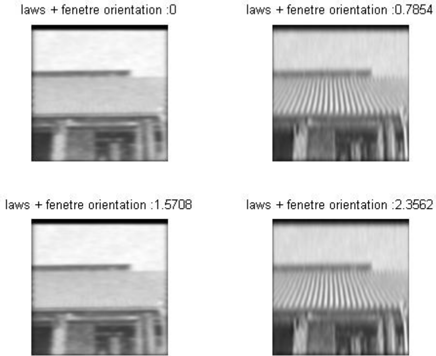
Figure IV.59 : résultat du filtrage par le masque L5E5 sur l'image T3 pour différentes orientations.
