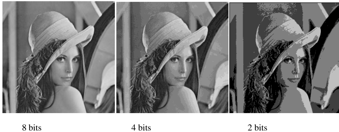
Figure I.12 : Images à différents codages des niveaux de gris.
