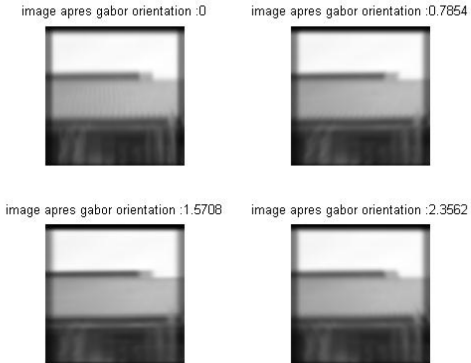
Figure IV.51 : résultat du filtrage de Gabor sur l'image T3 pour différentes orientations.
