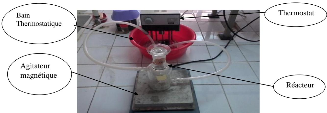
**Figure 5** : Dispositif des expériences d'adsorption
