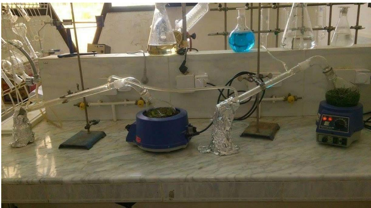
Figure 2 : photo montrant le dispositif utilisé pour l'hydrodistillation simple
