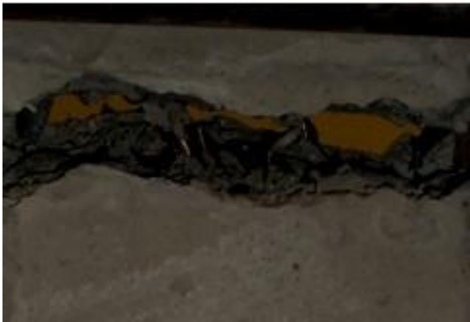
**Etape 2 :** les fibres retiennent les blocs de béton.
