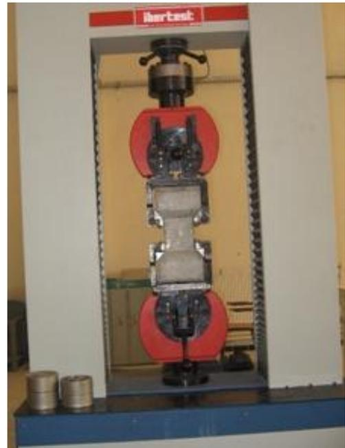
Figure 2-43 : Essai de traction
