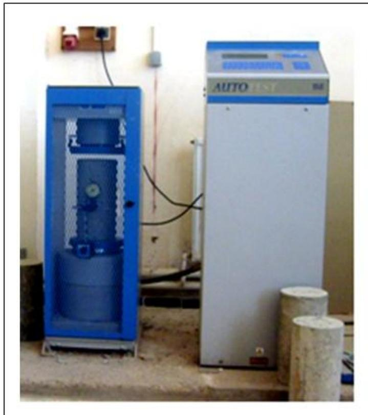
Figure 2-50 : Presse hydraulique AUTOTEST.
