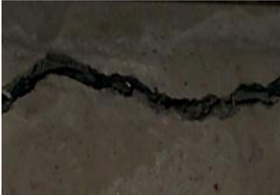
**Etape 1:** fissuration et rupture de la matrice en béton.
