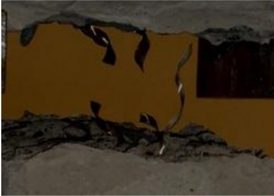
**Étape 5** : les fibres sont rompues, les deux blocs de béton sont séparés.
