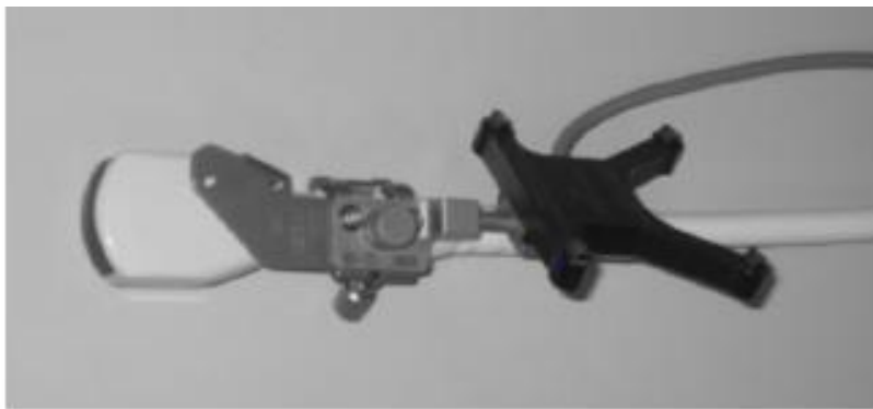
Figure 2.3. Système main-libre : un capteur de localisation (ici, de type optique) est fixé sur la sonde.
