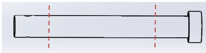
**Figure III.39:** représentation des sections cisailées sur la goupille
