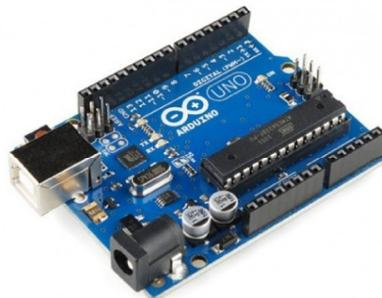
**Figure III.16:** Photo d'une carte Arduino uno
