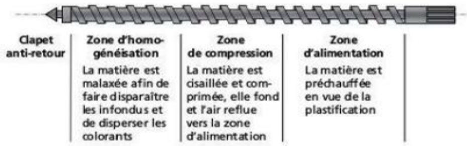
Figure III-14 : Profil d'une vis de plastification [25]
