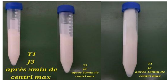
Figure III.49 : Stabilité à la centrifugation respectivement pendant 5,10 et 15min à 60k trs/min (J3).
