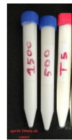
Figure III.32 : observation de la stabilité à la centri après 10min pour les différents variation de vitesse d'homogénéisations.
