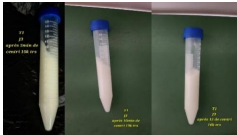
Figure III.48 : Stabilité à la centrifugation respectivement pendant 5,10 et 15min à 10k trs/min (J3).
