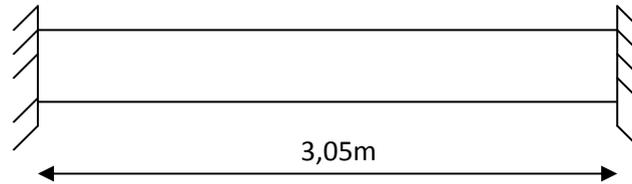
**Fig. III.2.1** : Schéma de la poutre palière.
