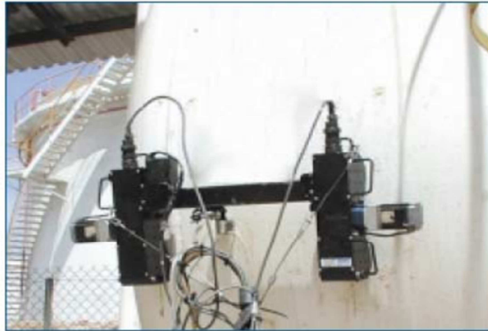
Figure I.19 : Photographie illustrant l'outil utilisé pour le contrôle par émission acoustique.
