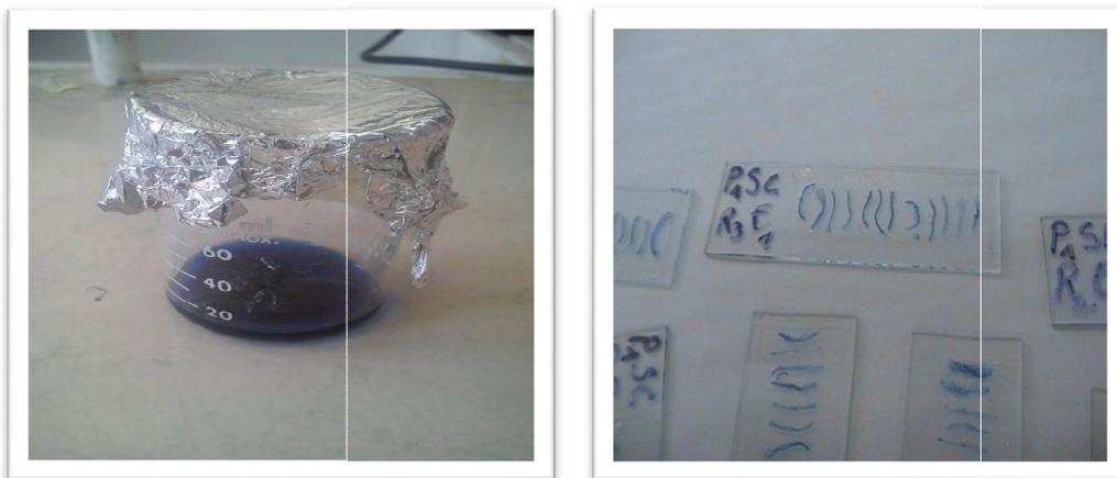
**Figure 18 :** Conservation et montage des échantillons racinaires colorés au Bleu de Trypan
