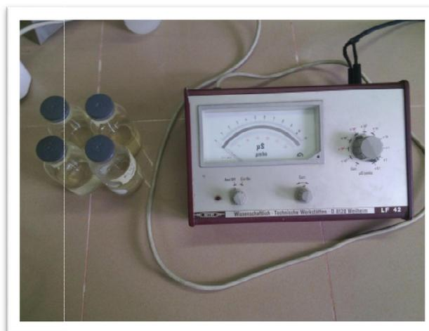
**Figure 17 :** Conductivimètre avec une électrode pour mesurer la conductivité
