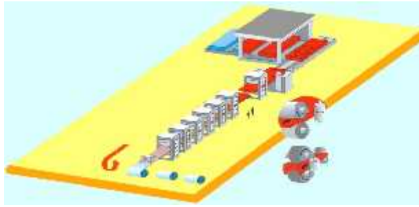
Figure II.1 - Schéma de principe d'élaboration par laminage [6]
