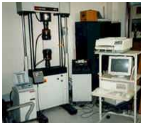
Figure I.11 - Essai est réalisé sur une machine de traction
