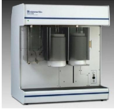
Figure II - 7 : Appareil d'adsorption-désorption de gaz Micromeritics ASAP 2020
