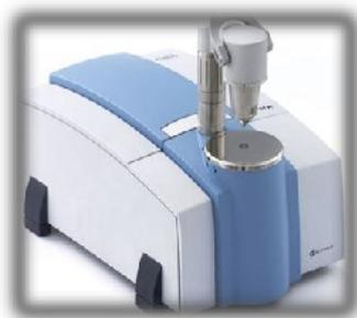
Figure II – 4 : Appareil de Spectroscopie FTIR-ATR (Alpha-Bruker)
