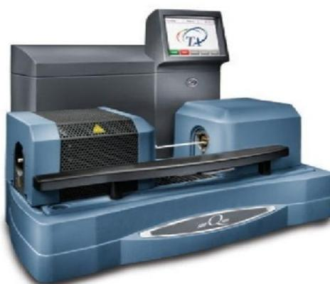
Figure II – 5 : Analyseur thermogravimétrique (ATD/ATG/DSC (SDT Q600 -TA))
