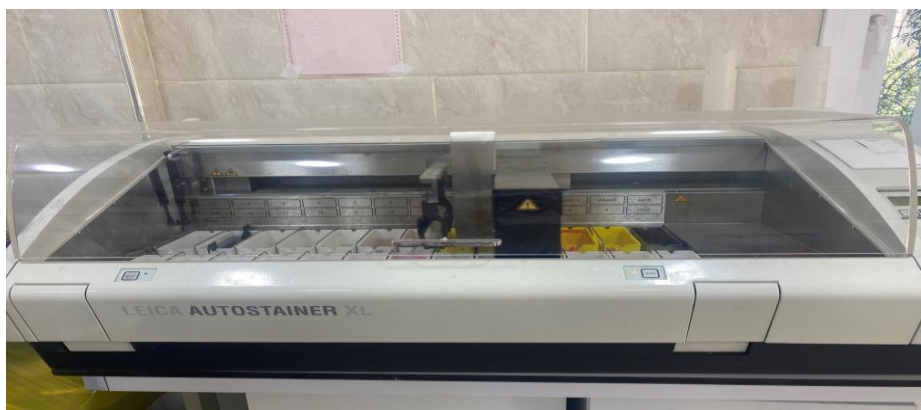
Figure 17: Réalisation de la coloration à l'aide de l'automate Leica ST5010 Autostainer XL
