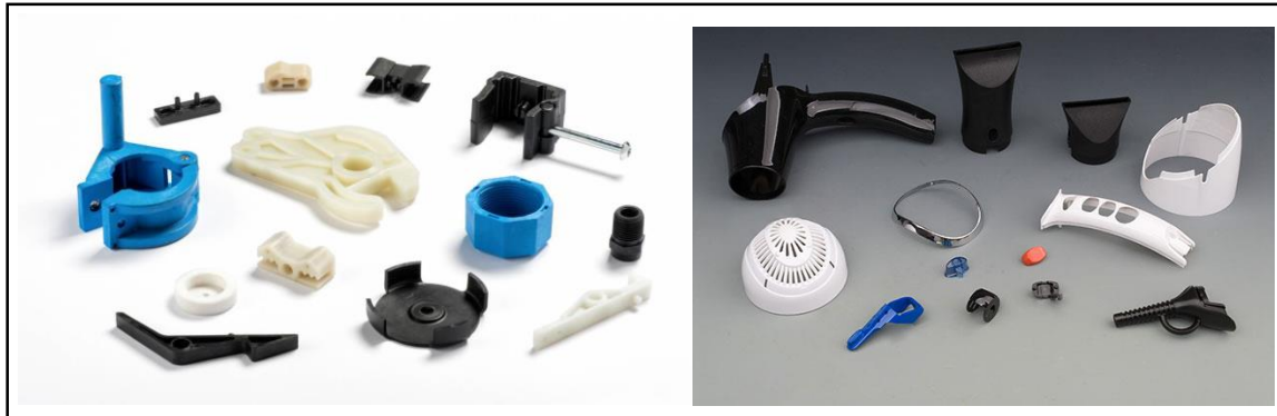
Figure 10 : Exemples de pièces obtenus par injection plastique.
