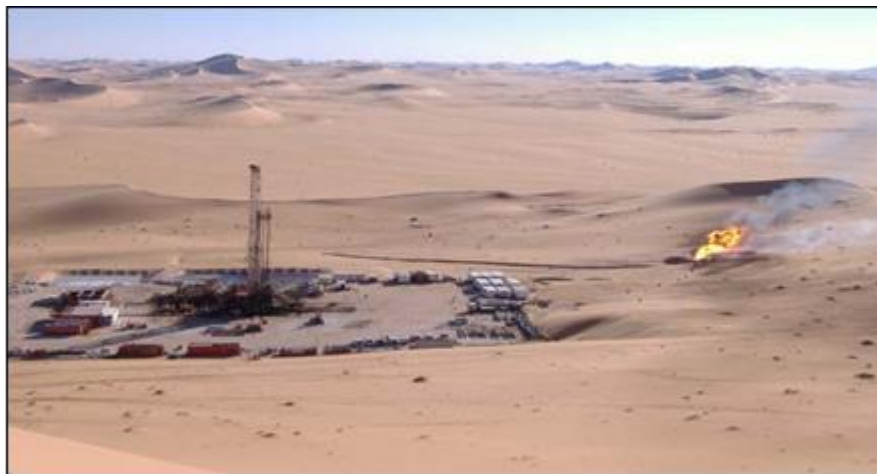
Figure 1.20 : Pour des raisons de sécurité, la torche est éloignée du forage à environ un (01Km)
