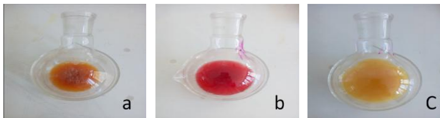
Figure 7 :(a) : Coloration du mélange réactionnel avant l'ajout de PP, (b) : après l'ajout de PP et (c) : à l'équilibre.
