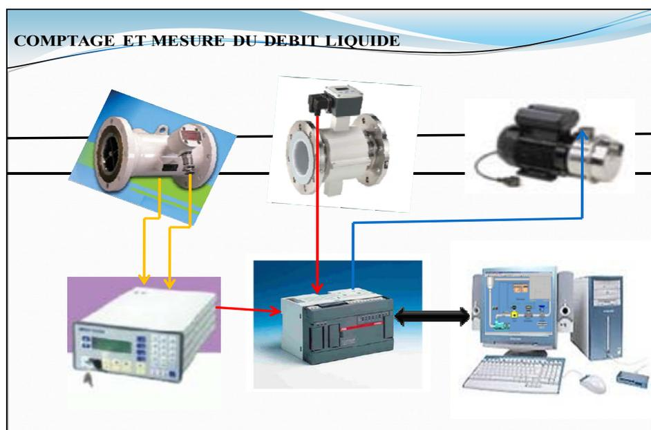
Figure (I.1) : chaine de mesure d'un débit
