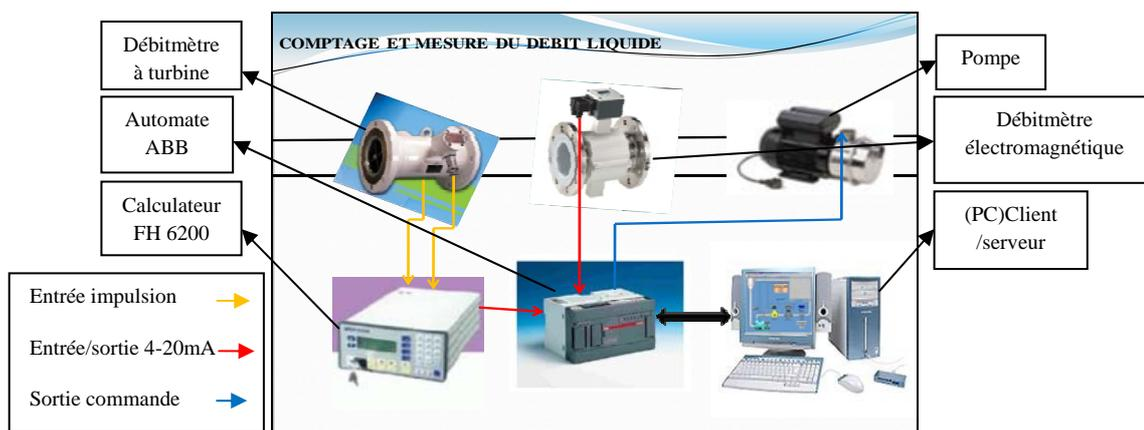
*Figure (V.1) : montre notre Banc de mesure et de comptage*
