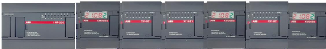
*Figure (III-5) : Unité centrale série 50 avec 6 modules extension.*
