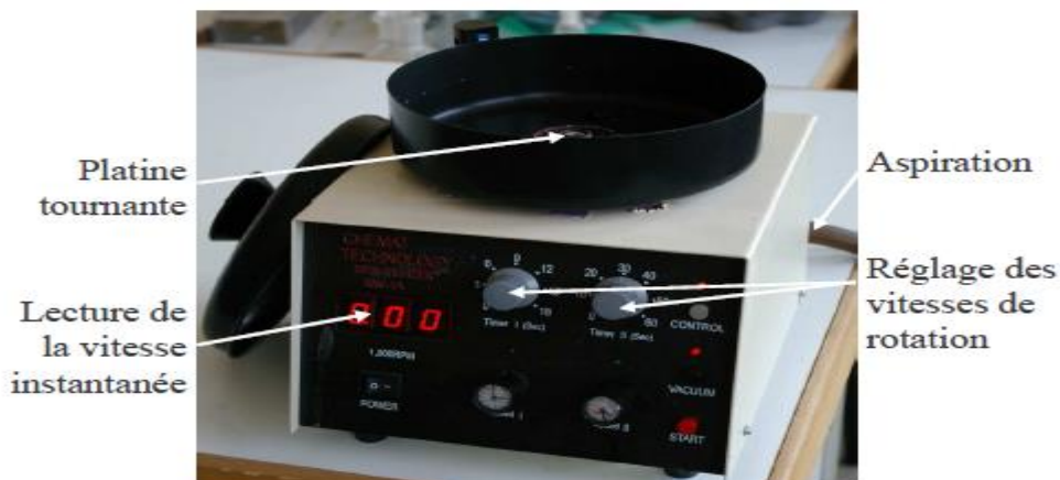
Figure (II-5) : Dispositif d'élaboration par spin coating
