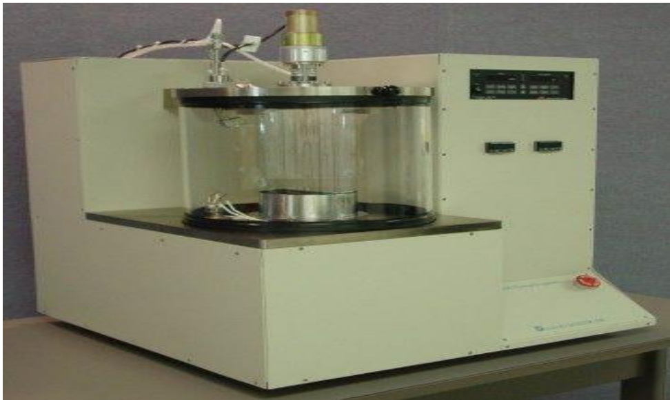
Figure (II-4) : dispositif d'élaboration par évaporation sous vide
