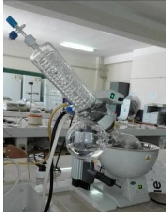
**Figure 11:** Photo originale de l'évaporateur rotatif.
