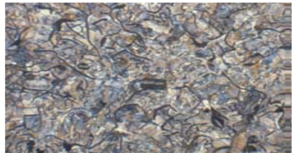
Figure. III.28: Fonte grise avec graphite non-attaquée dans matrice perlitique
