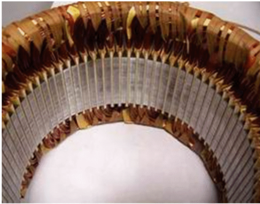
Figure. II.20: Stator avec bobinage
