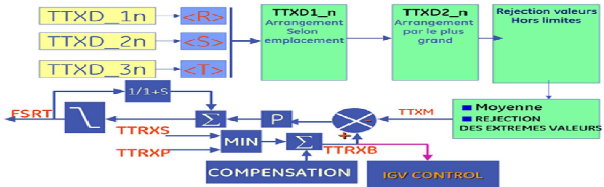
Figure III.10 : Boucle de contrôle de température
