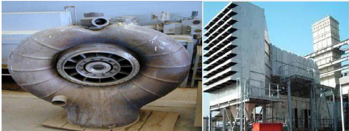
Figure II.15 : Echappement de la turbine.
