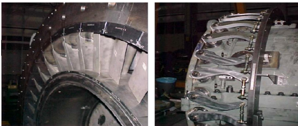
Figure II.13 : Nozzles 2 ème étage et mécanisme de variation.
