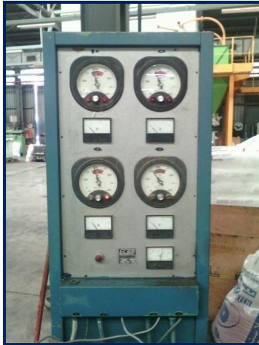
*Figure III 14 : tableau des paramètres d'extrusion*
