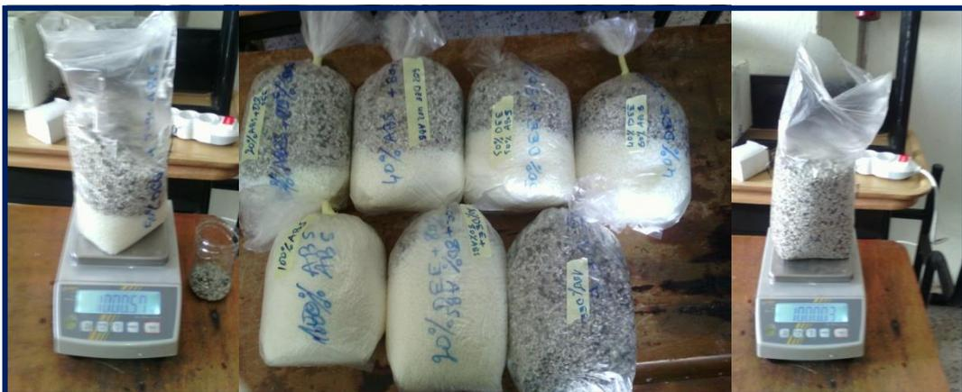
*Figure III 10 :* L'opération de pesée des mélanges ABS et déchets DEEE
