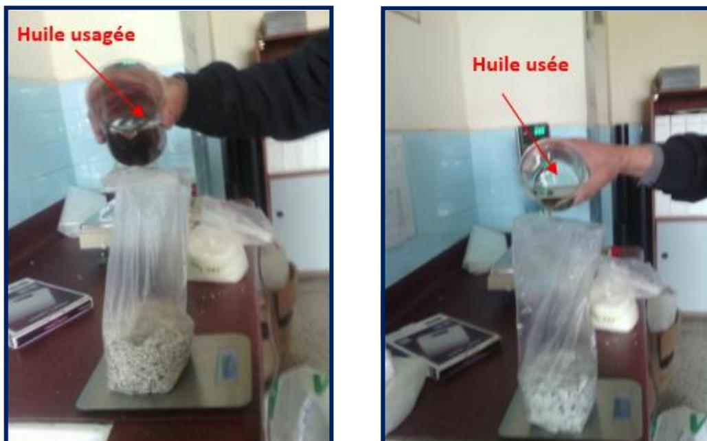
**Figure III 11:** Ajout 5% en poids d'huile de lubrification usagée pour chaque mélange
