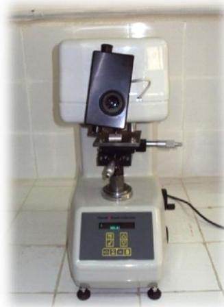
**Figure II 28:** Duromètre ZWICK/ROELL
