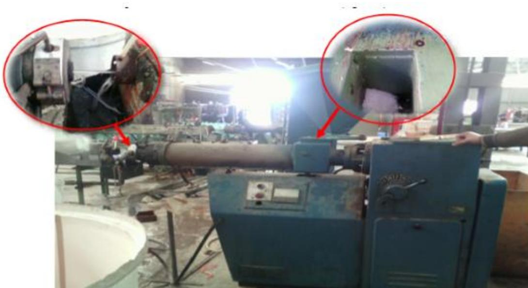
**Figure III 12 :** Extrudeuse mono vis *Marque NEBEL NEGRI-LUINO*
