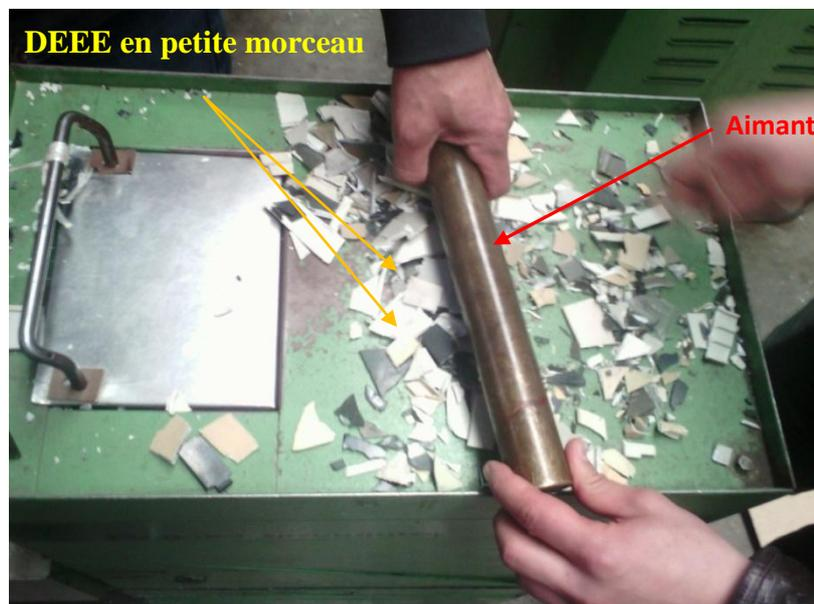
*Figure III 8 :* vérification la présence des particules métallique dans les déchets
