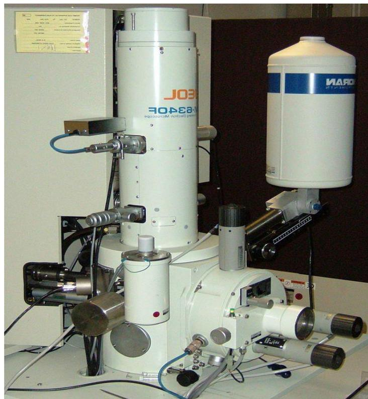
**Figure II.22** : Microscope électronique a Balayage
