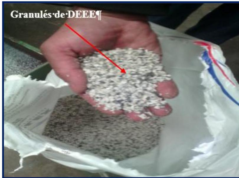
*Figure III 9:* les DEEE a l'état granulaire après le broyage
