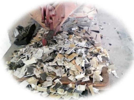
*Figure III 6* : Déchets découpés à la cisaille en petits morceaux avant broyage.
