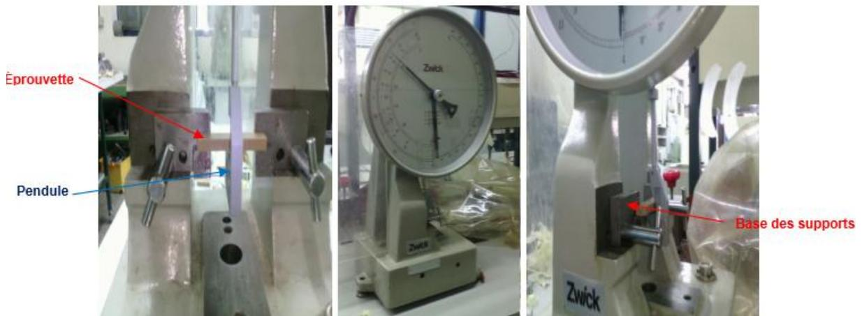
**Figure II.26** : Machine charpy de marque ZWICK a Electro-industries de Fréha
