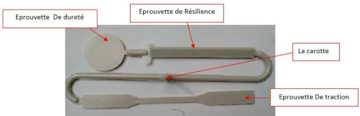
**Figure III 18 :** Eprouvettes obtenues après injection
