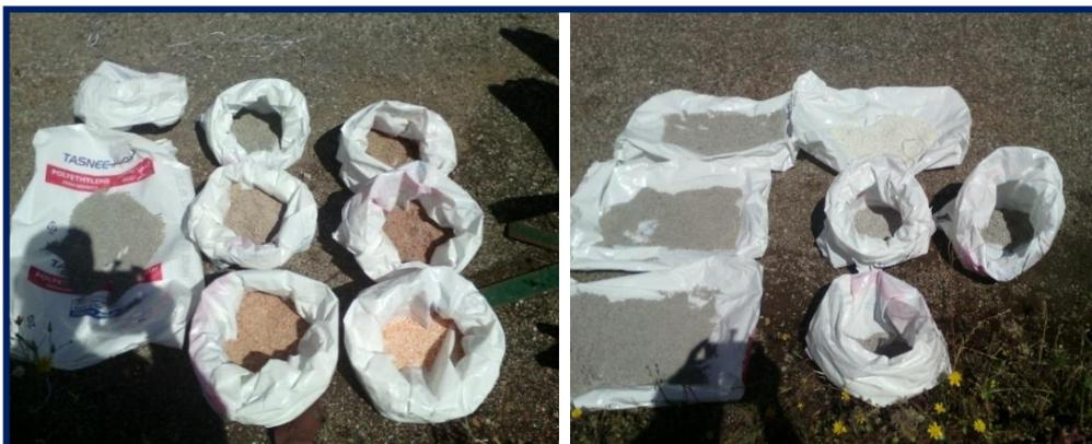
**Figure III 16 :** l'opération de séchage des matières broyées
