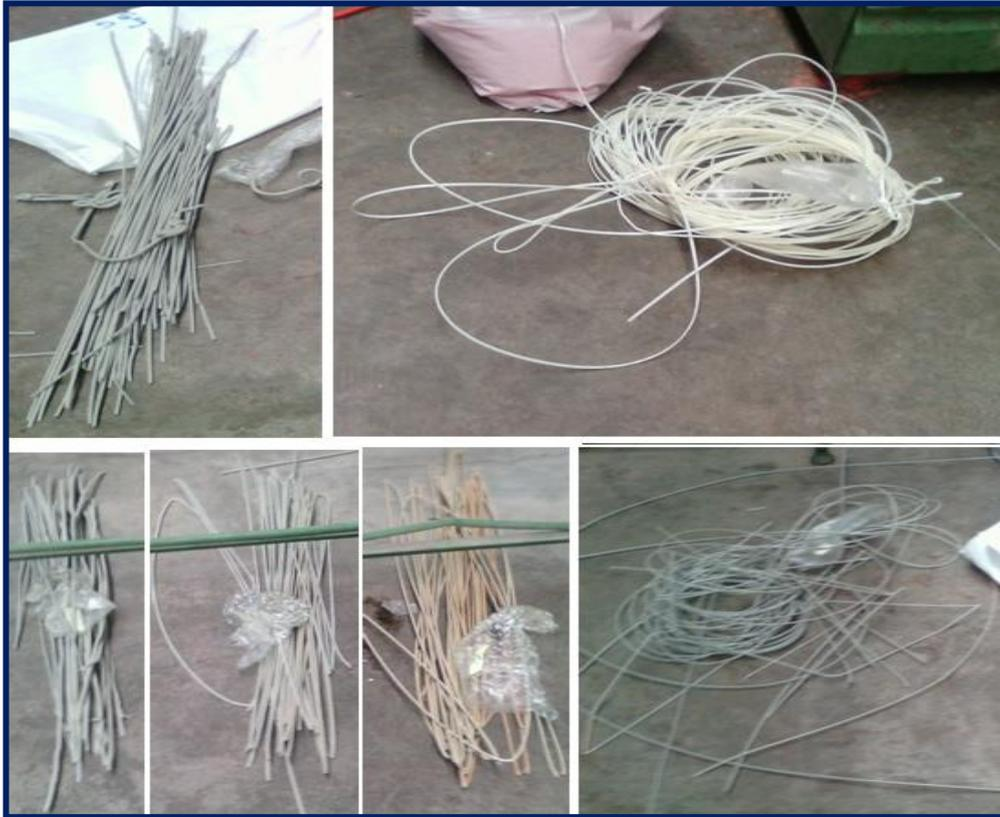
**Figure III 15 :** les mélanges après extrusion
