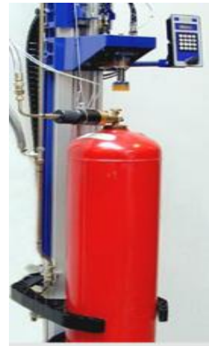
Figure II.15: détecteur de fuite.
