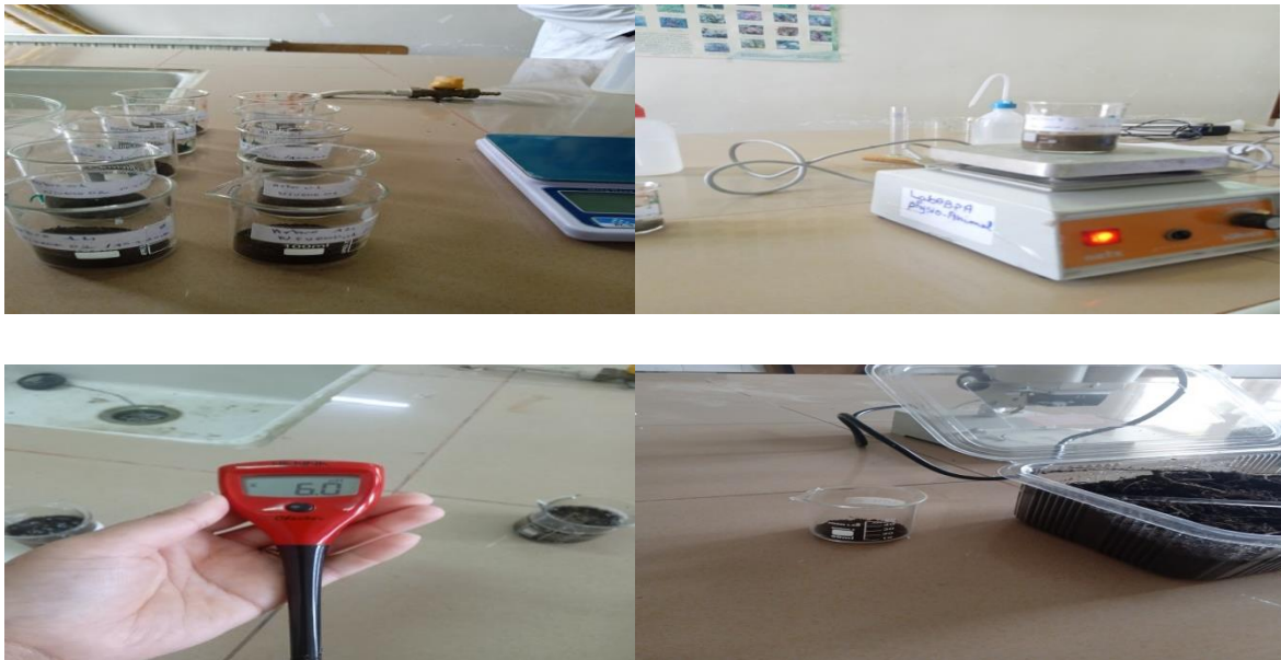
figure 16 ; Illustration de la mesure de PH eau
