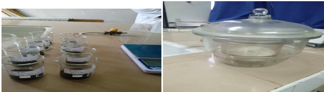
Figure 15 ; Illustration de la mesure de l'humidité
