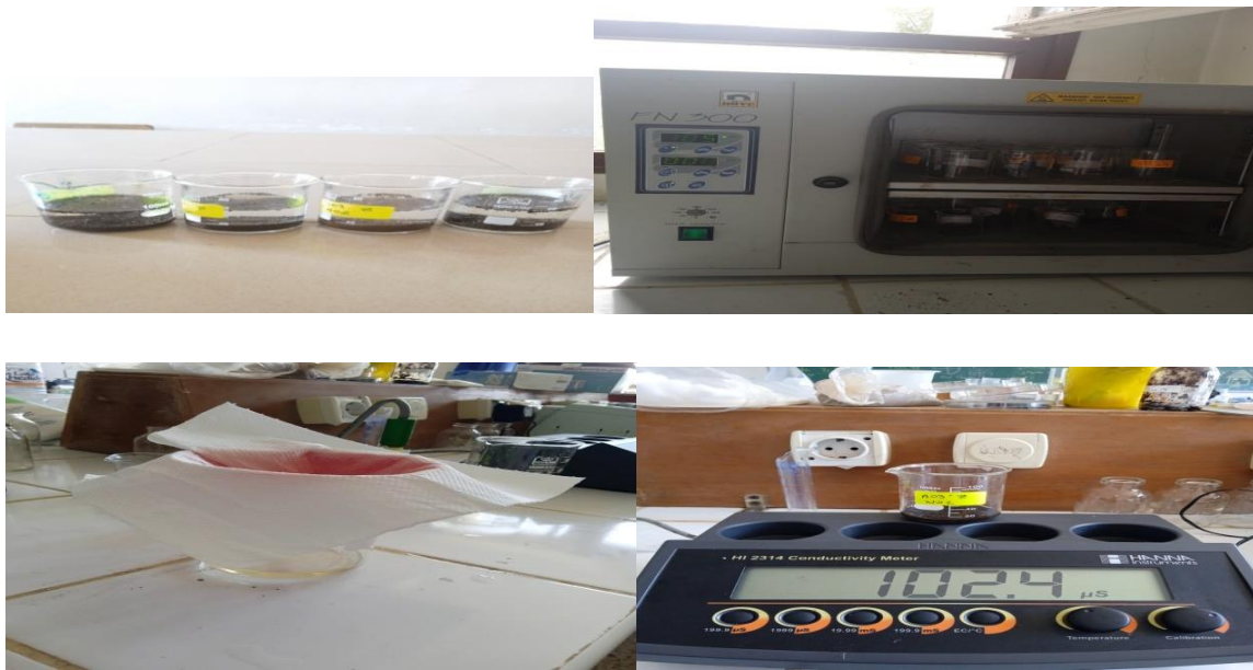
Figure 19 ; Illustration de la mesure de la C.E
