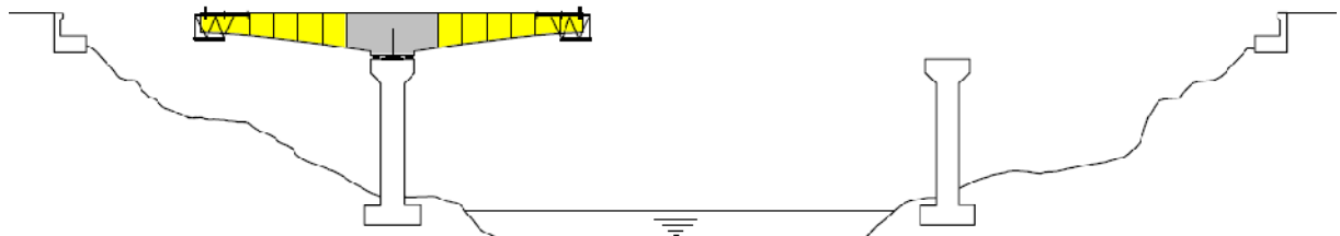
Figure 1.7 : Construction symétriques depuis une pile
