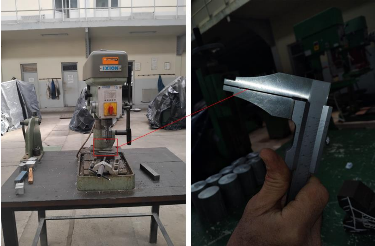
Figure 24: Perçage d'échantillon avec une mèche de 1.2 mm de diamètre.
