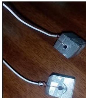
Figure 25: les échantillons reliés à un conducteur en cuivre.
