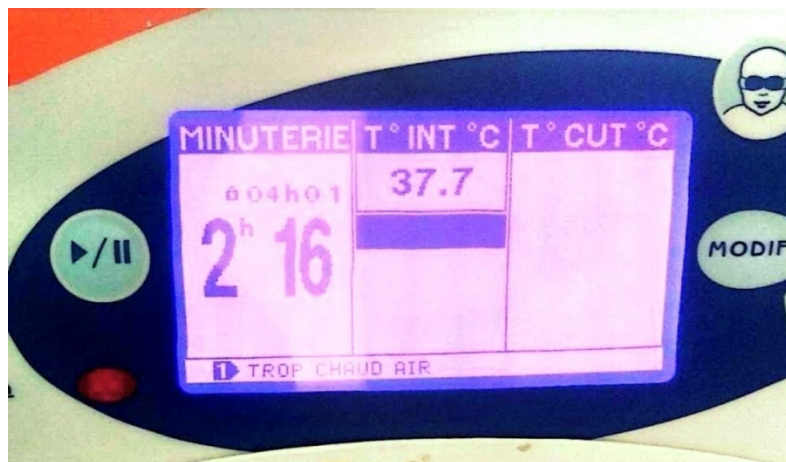
Figure 41: alarme « l'air trop chaud »
