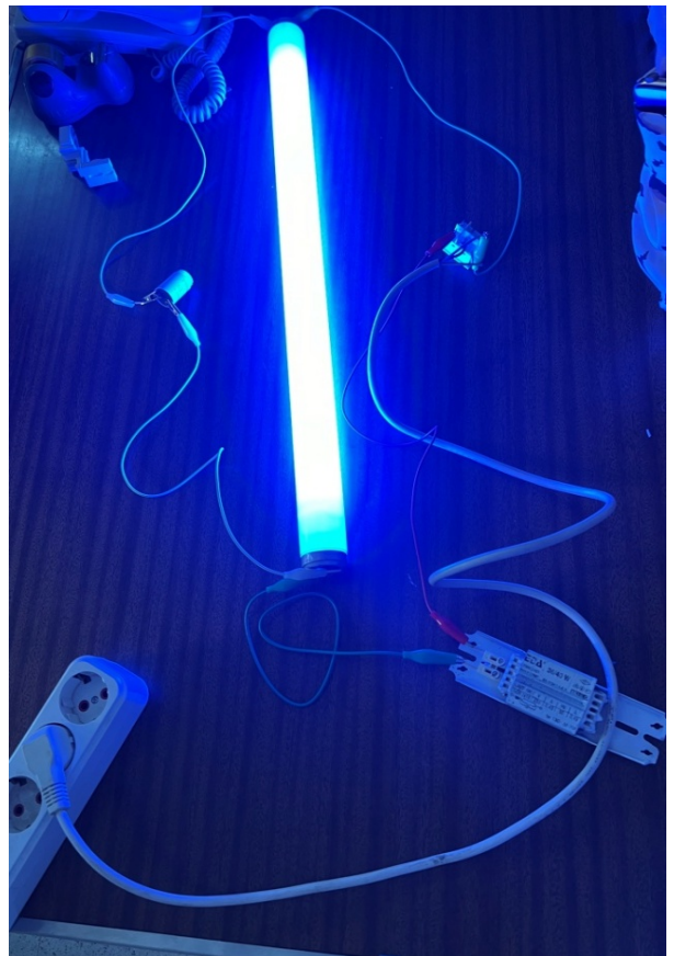
Figure 35: Circuit de branchement d'un tube fluorescent (photo prise durant le stage pratique à l'EHS SBIHD).
